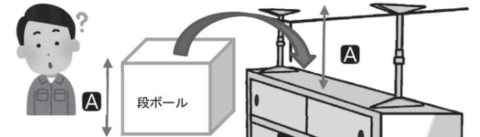
タンスや食器棚の突っ張り棒の他に家具と天井のスキ間に同じ高さの段ボールを探して入れましょう。これだけで、強度が補強されます。
